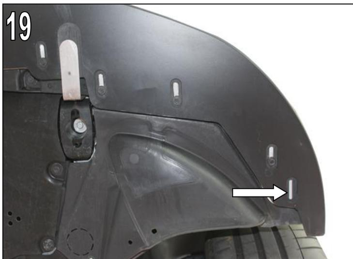
AC Schnitzer Frontsplitter demontieren.
